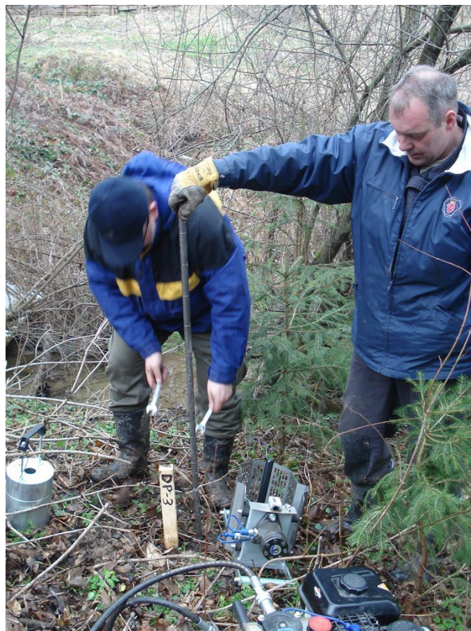
Slika 12: Sondiranje DP-3, desni breg, ob potoku
