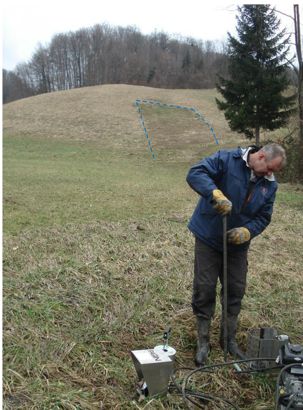
Slika 14: Sondiranje DP-5, levi breg potoka, zadaj na pobočju vlažno območje (modra črtkana linija)
