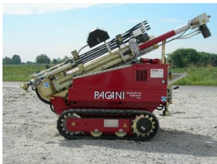
Slika 6: Dinamični penetrometer TG 63-100
